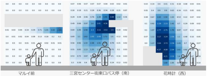
図 5 ミスト噴霧による気温低下量（℃）の計算結果の例
