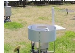
転倒マス型雨量計
