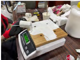
(a)主材と架橋剤を配合し、200～300g/m 2 を圧縮木材パネルにローラーで塗布する。
