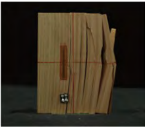
脆性的な破壊性状の例
