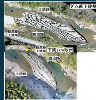
砂州のオルソ化画像と等高線 水頭の等高線と砂州内流れのベクトル
