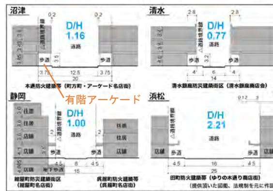
図5 沼津、清水、静岡、浜松の道路と建物の断面
