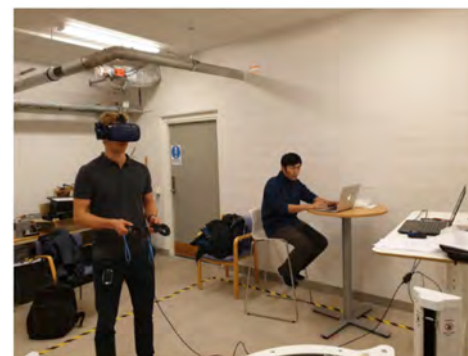
図2-1 仮想空間(VRを用いた実験空間)を用いた誘導灯での誘導効果実験の様子(Lund University)
