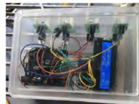
貯水槽水位の制御装置 (マイコンボードとタイマーリレー)
