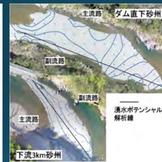
砂州のオルソ化画像と等高線 水頭の等高線と砂州内流れのベクトル
